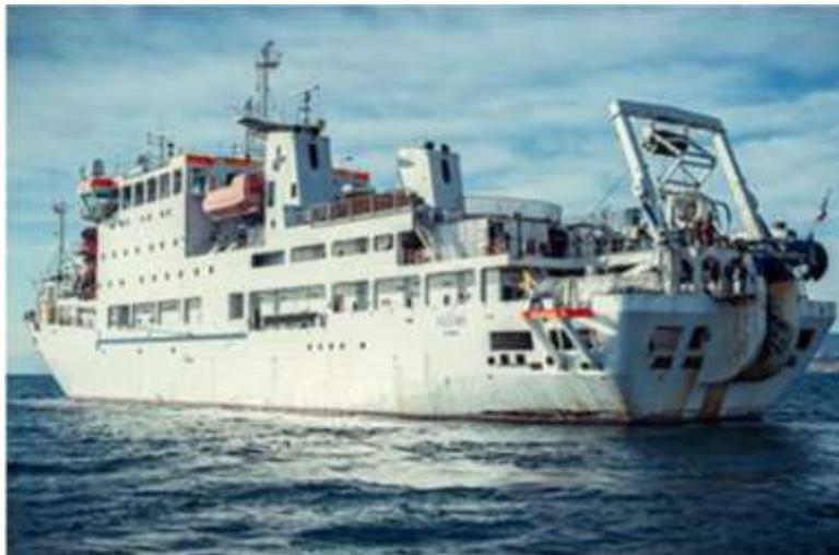
Ilustración 19 : Imagen de buque de instalación de cable TELIRI de Elettra
