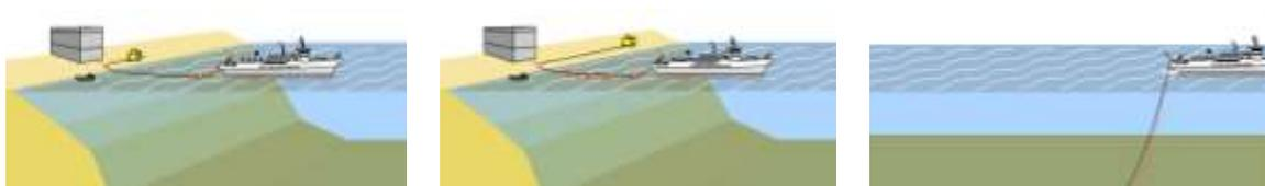
*Ilustración 17 Esquema de tendido en superficie del cable*
